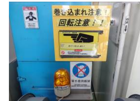
回転表示灯・指差呼称標識の設置
