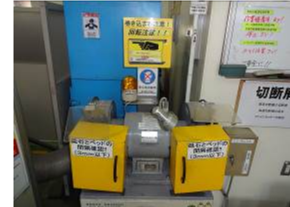
保護カバー・リミットスイッチの設置
