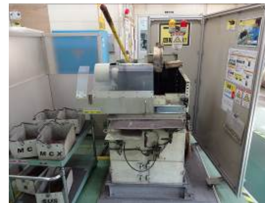
保護カバー・リミットスイッチの設置
