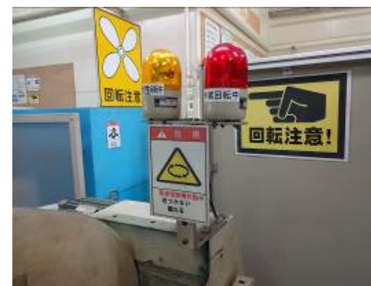
回転表示灯・指差呼称標識の設置
